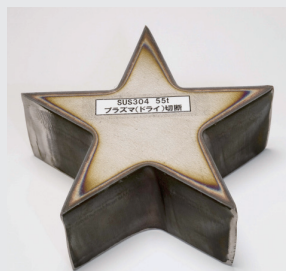
プラズマ切断 SUS304 厚55×巾143×長140mm 切断速度が最も速く、ガス切 断が困難なステンレス鋼やアルミ合金の切断に最適。
