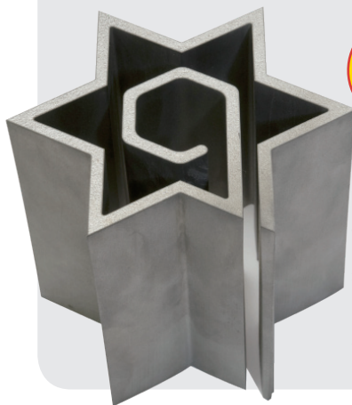
ウォータージェット 切断 SUS304 厚100×巾120× 長120mm 素材に熱を加え ない切断方法で あるため変質・ 変色・歪が発生し ない。
